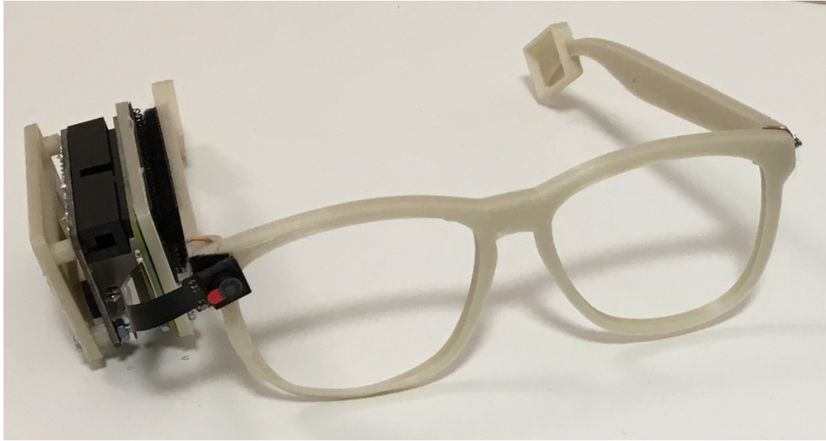
IDEM: brilleramme med mikro-computer og kamera
